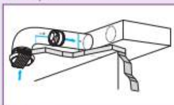
3/ MR stroomafwaarts van een ventilator
